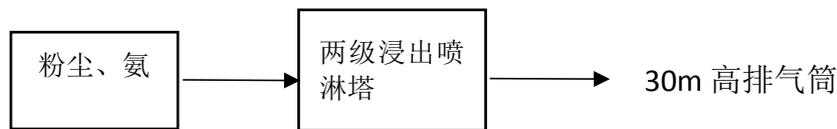
图 4-3 煅烧废气处理工艺流程图
