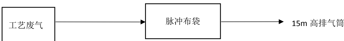
图 3-2 2t/h 蒸汽发生器废气处理流程图
